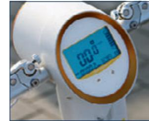
Gute Lesbarkeit garantiert ein Display, das Details wie Geschwindigkeit, Akkustand oder die Betriebstemperatur anzeigt. Per Knopfdruck stehen vier unterschiedliche Drehmomentstufen zur Auswahl.
